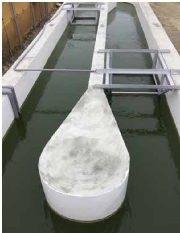
圖2、以創新藻菌系統處理畜牧廢水之40噸模擬測試系統
