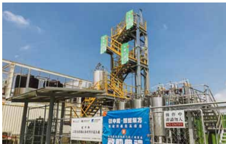
負碳排示範工廠未來將在中油、中鋼、台電、 台塑等碳排大戶企業放大建置，將CO 2 資源化， 作為石化原料的新碳源
