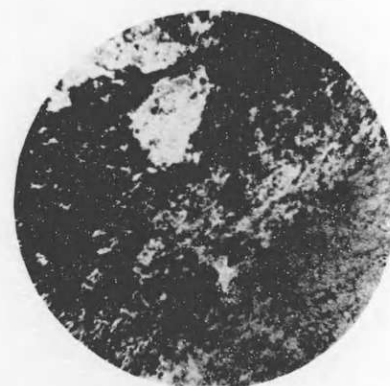
症狀マンガン鑛の黑色部と薄桃色部との境界を示す薄片顯微鏡寫眞(×55)
