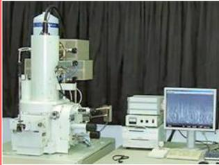
本電腦化操作之高解析場發射掃描式電子顯微鏡，其特點為以冷場發射電子槍產生探測電流範圍較低及能量均一之電子束，適合熱敏感樣品之分析，並在低加速電壓下，亦可獲得高解析品質之影像。能提供金屬材料、電子材料及高分子材料等於高倍率下之二次電子影像(SEI)及背反電子影像(BEI)之表面型態觀察。本機台同時配置有能量分散光譜儀(EDS)能做元素成分之定性及半定量分析之工作。
