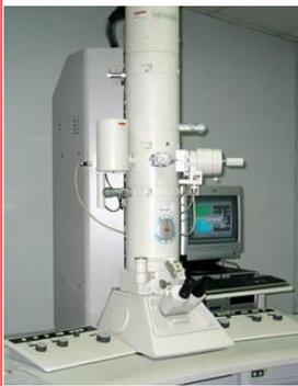
H-7500 型穿透式電子顯微鏡光源是傳統的鎢絲燈。電子流過燈絲尖端再以高電壓（~40-120kV）將電子加速，經過電磁透鏡聚焦，穿過樣品投射於 CCD 顯示器，達到高解析品質之影像。本儀器可提供奈米材料、高分子材料、生物樣品，及超薄切片樣品之內部結構、粒子型態尺寸之觀察。
